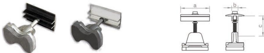
Morsetto intermedio per il fissaggio dei moduli sul binario a C o binario C-N. Vite di serraggio con testa esagonale esterna SW 8. Per spessori del modulo di 30-42 mm, disponibile in colore alluminio o nero anodizzato.
