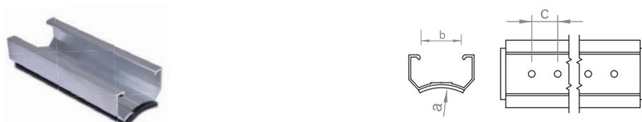
Profilo corto con diametro foratura 5,2 mm e guarnizione preassemblata per l'installazione in orizzontale del modulo su lamiera ondulata, raggio 39,4 mm. Il serraggio avviene senza asportazione di trucioli con la vite di fissaggio per lamiera metallica.
