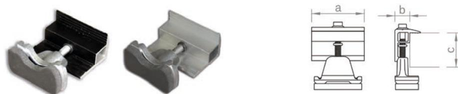
Morsetto terminale per il fissaggio dei moduli sul binario a C o binario C-N. Vite di serraggio con testa esagonale esterna SW 8. Per spessori del modulo di 30-42 mm, disponibile in colore alluminio o nero anodizzato.
